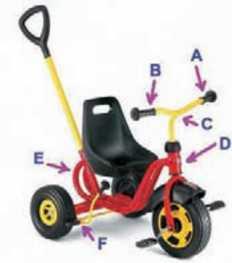
Abb. 81: Vorschläge für Stellen, an denen man Baugruppen anbringen kann: (A) und (B) Schalter für die gesamte Elektrik, (C) elektronisches Display, (D) Vorderscheinwerfer, Blinker und Nummernschild, (E) Rücklichter, Blinker und Nummernschild, (F) Schalter für Bremslicht.
